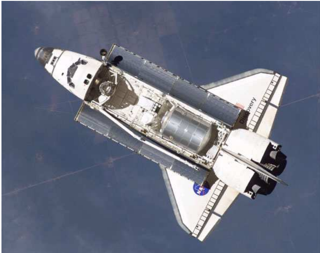
Foto: Opname vanuit het ruimtestation ISS waar spaceshuttle Discovery op missie STS-121 net onder het ruimtestation zweeft om te gaan aanmeren. In het vrachtruim is de Leonardo Multipurpose Logistics Module te zien. Credit: NASA
