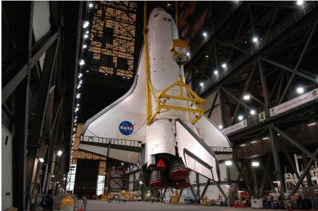
Foto: Spaceshuttle Atlantis wordt in het Vehicle Assembly Building (VAB) op het Kennedy Space Center in Florida opgetakeld om op de externe brandstoftank gemonteerd te worden. Credit: NASA
